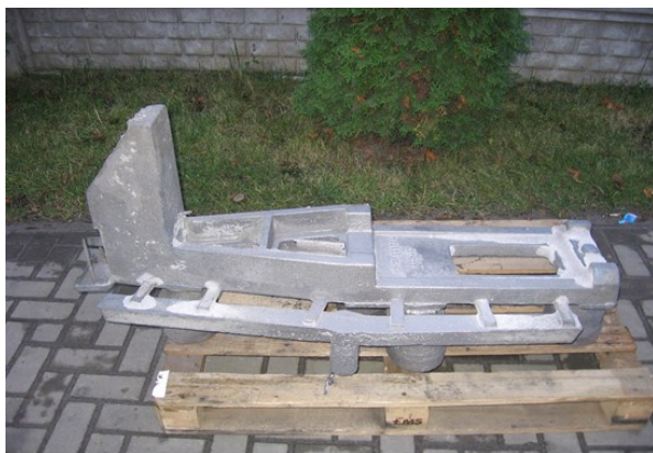
Rys. 4. Odlew podstawy stacji o masie 102 kg. GJS 400-15
